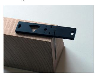
Den Stelldraht in die benötigte Bohrung stecken und noch einmal auf richtige Positionierung im Schieber prüfen.
