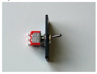
Die Schalterplatte wird mit 4 Zylinderkopfschrauben M 3x6 unter die Drehmechanikebene geschraubt. Darauf achten, das sich die ovalen Aussparungen auf der Stelldrahtseite befinden.
