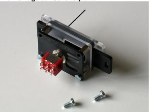
Die Schalterplatte wird mit den M3x6 mm Zylinderkopfschrauben unter die Drehmechanikebene geschraubt. Darauf achten, dass sich die ovalen Aussparungen auf der Stelldrahtseite befinden.
