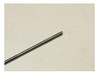
Die so entstandene Riffelstruktur garantiert später eine gute Klebeverbindung zwischen Metall und dem Kunststoff.
