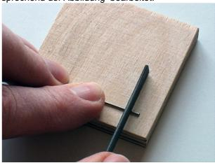
Die schmale Kante einer Nadelfeile wird mit etwas Druck über den Draht gerollt (nicht feilen), so dass sich eine Prägung abzeichnet.
