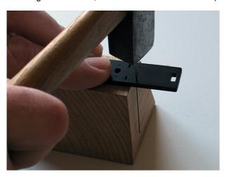
Etwas Klebstoff an die Prägung geben, danach den Stelldraht mit dem Hammer einschlagen.
